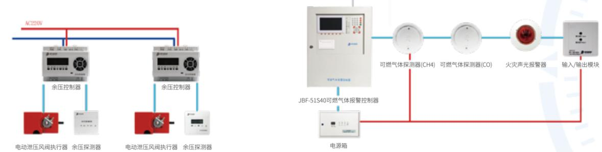
■ 24V电源线 ■ 信号线 ■ CAN总线
