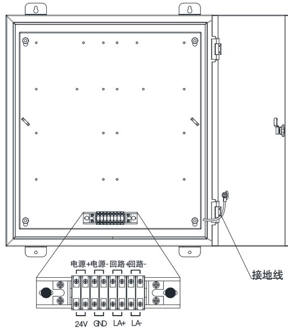
推荐接地线和端子接线图
