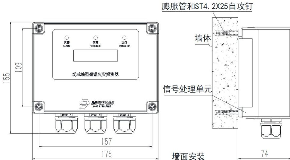
图 1 室内墙面安装示意图
