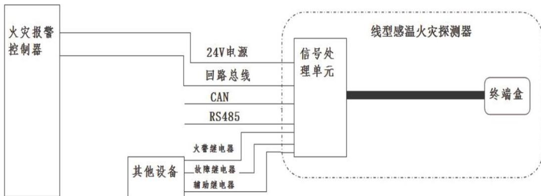
图 7 产品系统配接示意图
