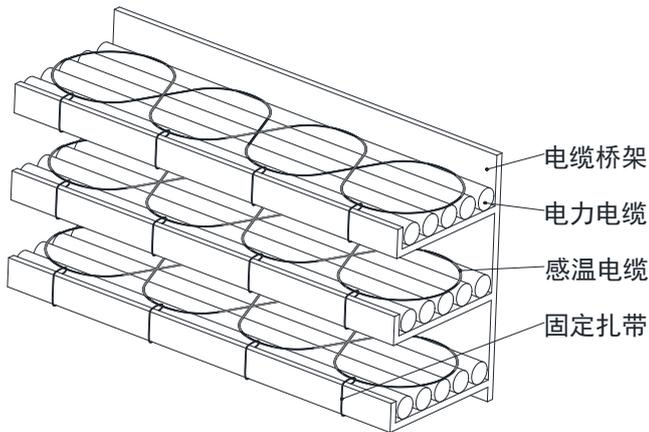
图 5 感温电缆敷设工程安装示意 2（线缆桥架应用为例）。
