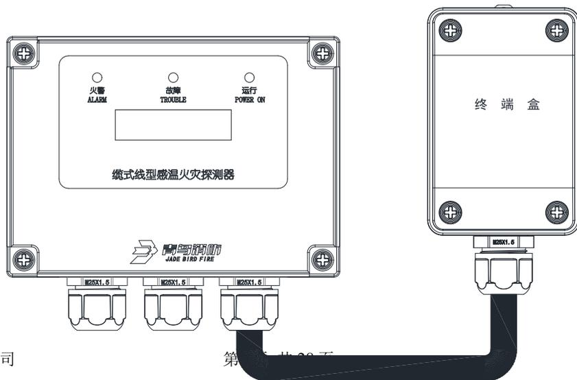
JTW-LCD-JBF4310-1 型缆式线型感温火灾探测器是青鸟消防开发的具有自主知识产权的新型数字缆式线型感温火灾探测器。该探测器满足 GB 16280-2014《线型感温火灾探测器》国家标准，由信号处理单元、敏感部件（感温电缆）、终端盒三部分构成，探测器以高度智能的温度信号处理方式对整条线缆的实时监测；增配温度场监测系统，可对温度场进行分布式智能处理，可以给出温度分布细节、温度场、温度变化趋势和精准的温度绝对值。
