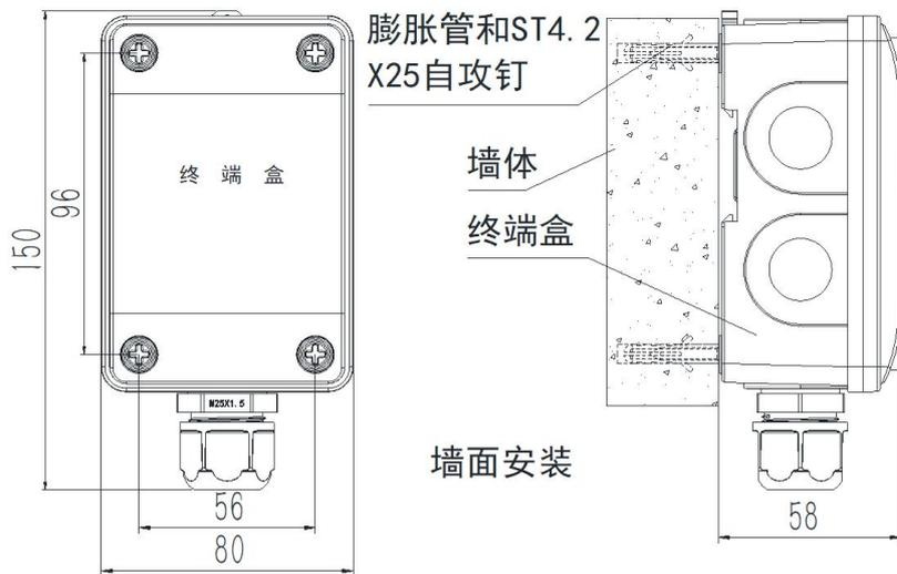
图 3 终端盒的安装示意图
