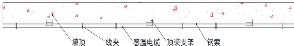
图 4 感温电缆悬挂工程安装示意 1（隧道安装应用为例）
